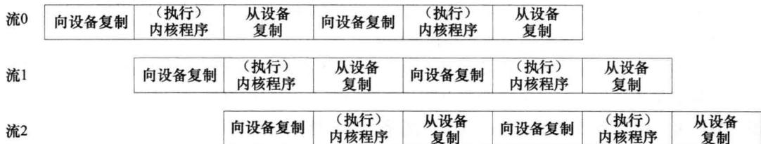
图 3-8 流的流水线处理技术
