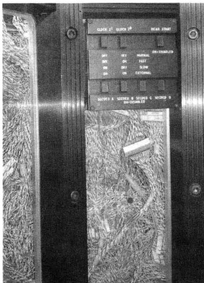
图 1-3 Cray-2 超级计算机的内部连线
