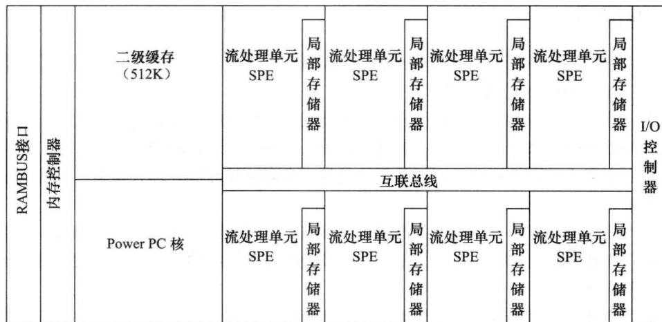
图 1-4 IBM Cell 处理器芯片布局（8 个 SPE 版本）
