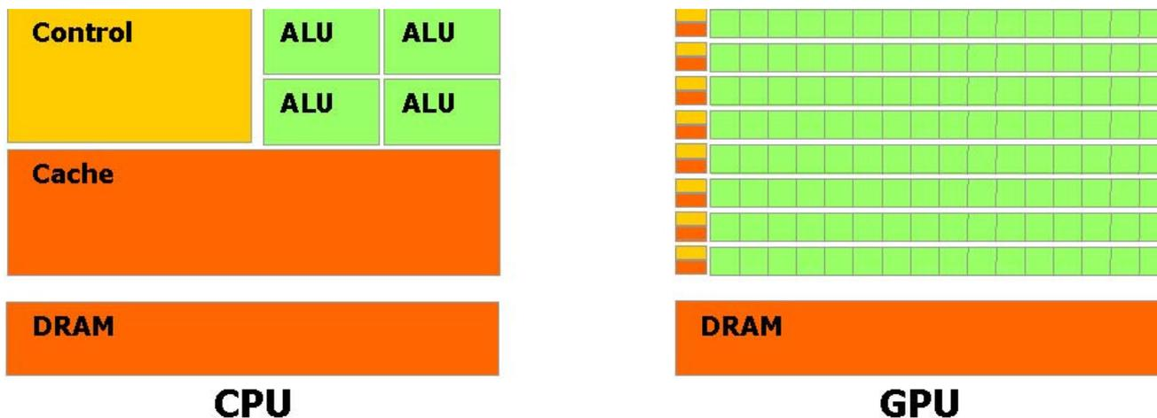
图1-2。 GPU 投入更多晶体管进行数据处理
